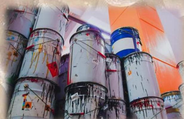
Fig.2-I fusti di vernice, anche vuoti non ripuliti, possono essere pericolosi a causa del precedente contenuto di solventi
