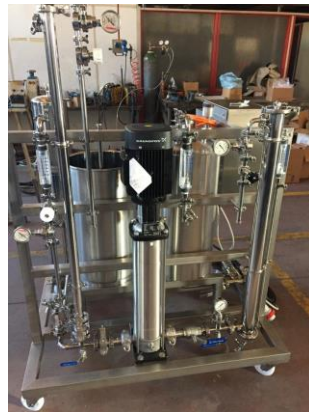
Impianto di separazione e concentrazione a membrana (MF-UF-NF e osmosi inversa)
